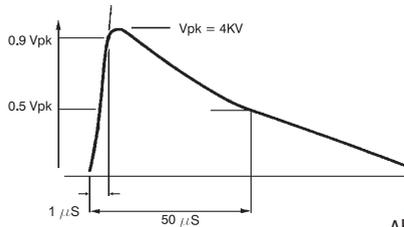
Abb. 4.2 Spannungsspitzen
