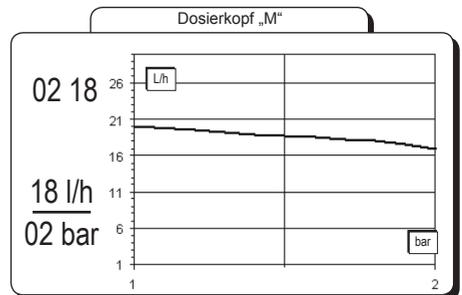
Alle Angaben zur Literleistung beziehen sich auf Messungen mit H<sub>2</sub>O bei 20 °C und dem angegebenen Gegendruck. Die Dosiergenauigkeit liegt bei ± 2% bei einem konstanten Gegendruck von ± 0,5 bar.
